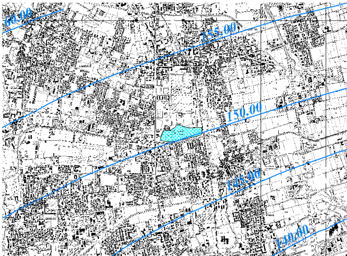
Fig. 11: Carta della piezometria della prima falda al settembre 2013 (fonte: Provincia di Milano - ridisegnata) su CTR, con localizzazione della vasca di progetto
